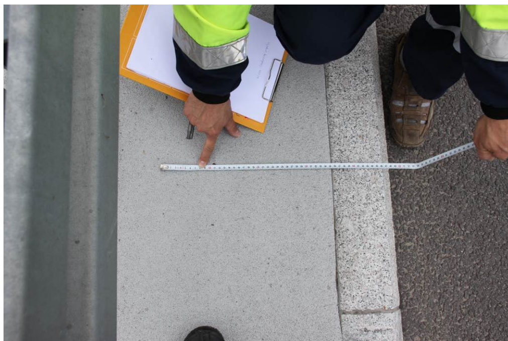
Rys. 4.2. Pomiary kontrolne szerokości pasa bezpieczeństwa wzdłuż barieroporęczy
