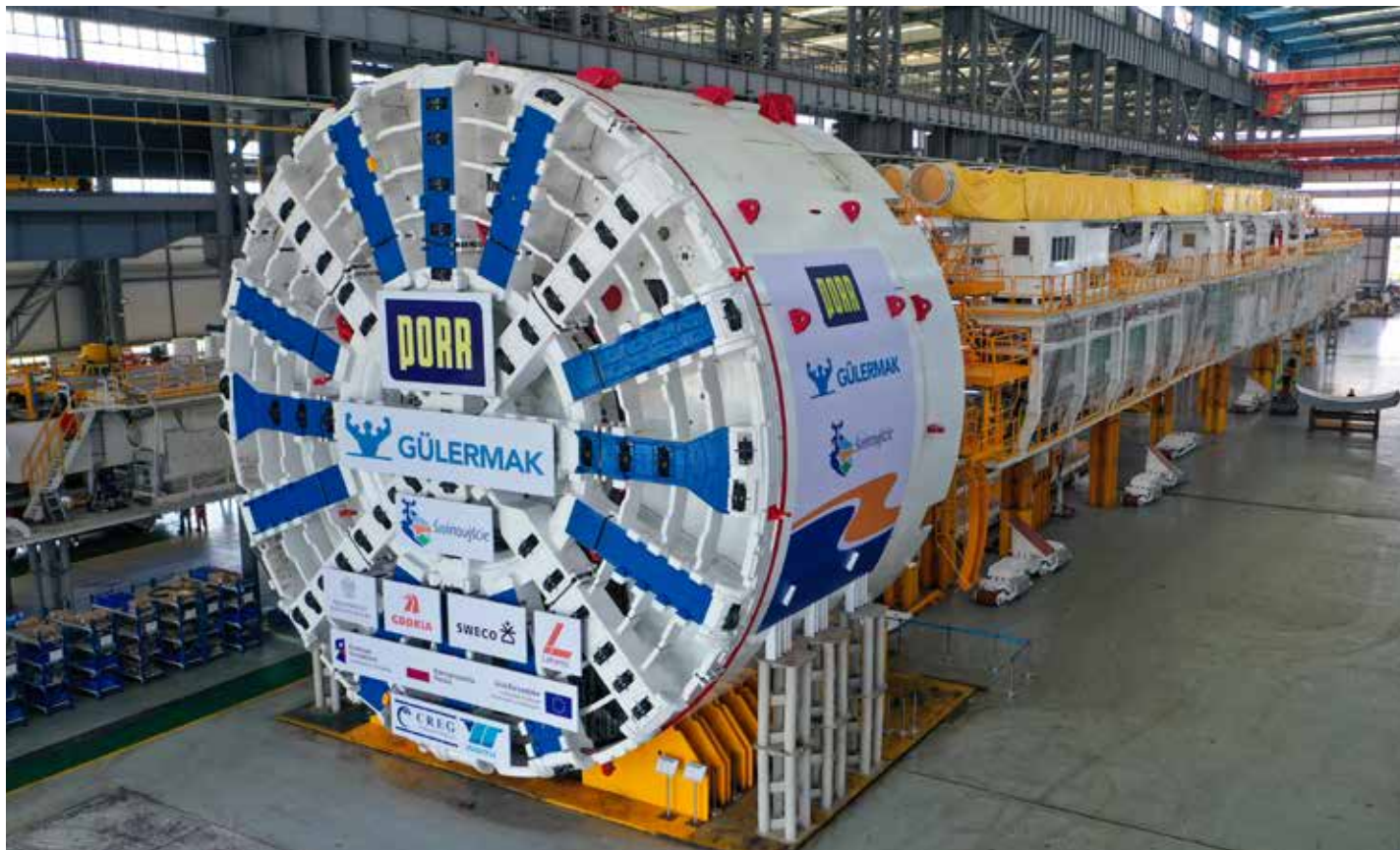
To ten kolos wydrążył tunel pod dnem Świny. Na zdjęciu maszyna TBM jeszcze u producenta w Chinach.
